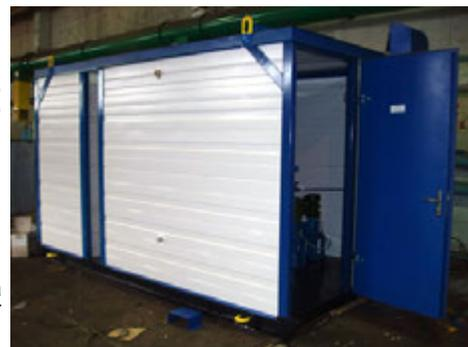
Автоматизированный блок БПЖТ предназначен для подготовки жидкого топлива, используемого на установках для нагрева нефти (путевые подогреватели, автоматизированные нефтеногревательные печи) и других аппаратах с огневым подогревом.
